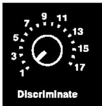
Dient zum Einstellen des Grades der Ausfilterung von Metallen
