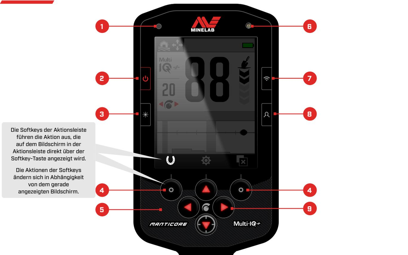
Die Softkeys der Aktionsleiste führen die Aktion aus, die auf dem Bildschirm in der Aktionsleiste direkt über der Softkey-Taste angezeigt wird.
