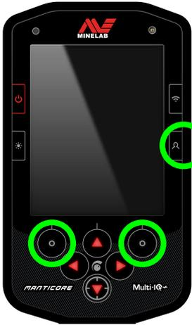
Der **seitliche Softkey** ist die untere rechte seitliche Taste am Bedienfeld. Für die dieser Taste zugewiesenen Aktionen wird kein Symbol angezeigt, bis der Softkey gedrückt wird.
